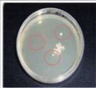
Apia-mist 設置2階フロア空中浮遊菌サンプリング培養結果写真
